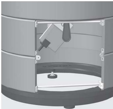
Obr. 3.2 Stavěcí podstavce pod dnem zařízení, sejmutý kryt
