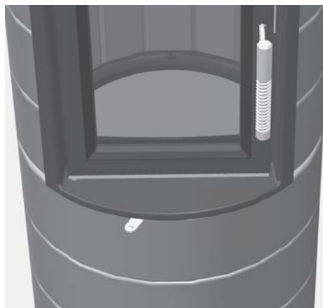
Obr. 4.3 Šoupátko spalovacího vzduchu, vlevo, zcela zavřené
