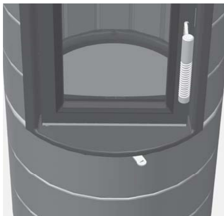
Obr. 4.4 Šoupátko spalovacího vzduchu, vpravo, zcela zavřené
