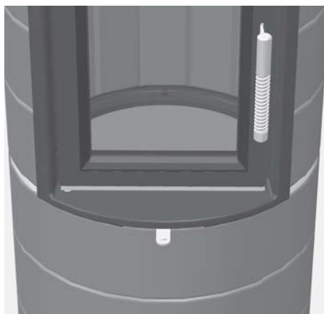
Obr. 4.5 Šoupátko spalovacího vzduchu, uprostřed – provoz se jmenovitým tepelným výkonem
