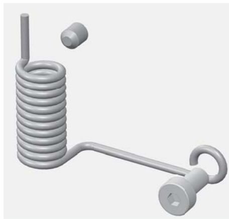
Obr. 3.6 Pružina dveří, stavěcí šroub a připevňovací šroub
