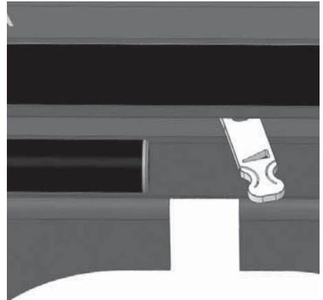
Abb. 3.8 Luftschieber ganz rechts, über den Anschlag hinaus, in Anheizstellung
