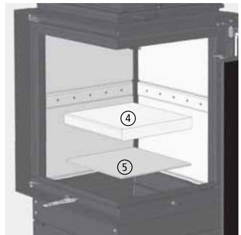
Abb. 3.16 Bodenstein und Bodenblech entnehmen
