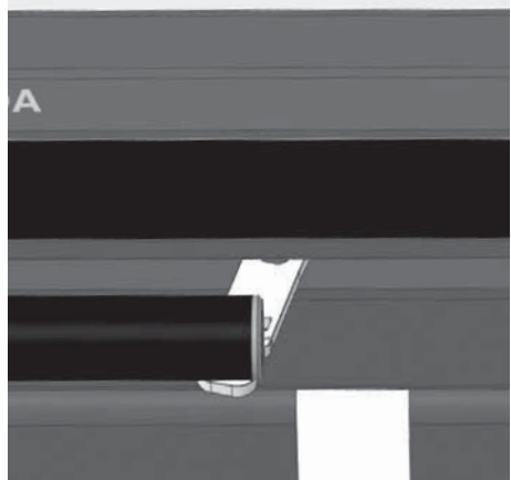
Abb. 3.10 Luftschieber ganz links, Verbrennungsluft geschlossen
