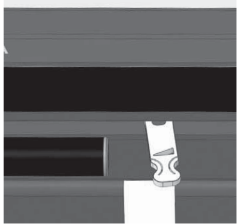
Abb. 3.9 Luftschieber rechts, bis Anschlag Verbrennungsluft komplett geöffnet
