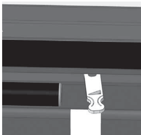
Abb. 3.6 Luftschieber rechts, bis Anschlag Verbrennungsluft komplett geöffnet
