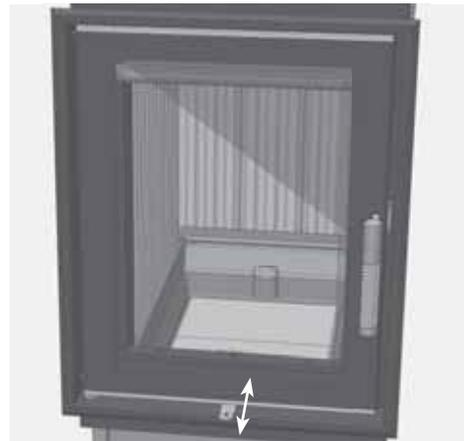
Abb. 3.7 Verbrennungsluftschieber zur Hälfte heraus gezogen
