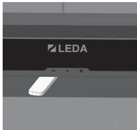
Abb. 3.9 Luftschieber ganz links, Symbol „-“ Verbrennungsluft geschlossen
