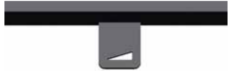
Abb. 3.7 Verbrennungsluftschieber halb rechts bis mittig
